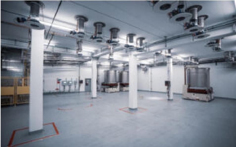
*Das Komponieren von lose angelieferten Rohstoffen direkt in die Chargencontainer erfolgt durch fahrerlose Transport-Fahrzeuge an autonom angesteuerten Andockpunkten. © STAMAG*
