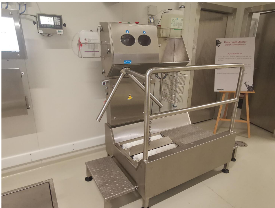
Zwangsgeführte Hygiene durch separate Wege zwischen Produktion und Sozialbereich ermöglicht kontrollierte und manipulationssichere Sohlenhygiene. © Beigestellt
